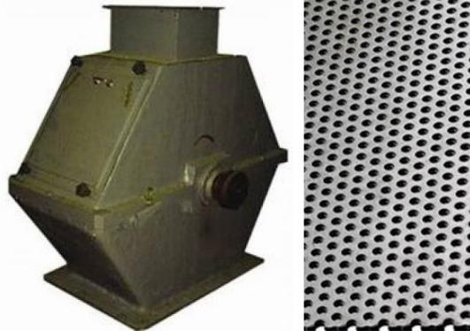
**Дробилка зерновая молотковая ДДМ-5 (с производительностью до 3 т/ч.). Размер решетных полотен (сит) 500\*1574 без кромок, холодно-катанный металл. Большой ассортимент комплектующих и запасных частей в наличии и на заказ.**
