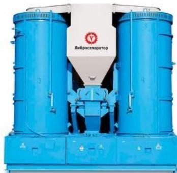
**Зерноочистительная машина БЦСМ-25/50/100 и ее модификации** (сепаратор виброцентробежный зерновой с производительностью до 100 т/ч.). Размер решетных полотен (сит) 490\*990 гнутые. Большой ассортимент комплектующих и запасных частей в наличии и на заказ.
